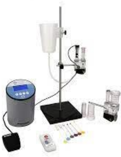
Máy đo thể tích bàn chân chuột (Plethysmometer, Cat. No 7140, Ugo Basile – Italy)
